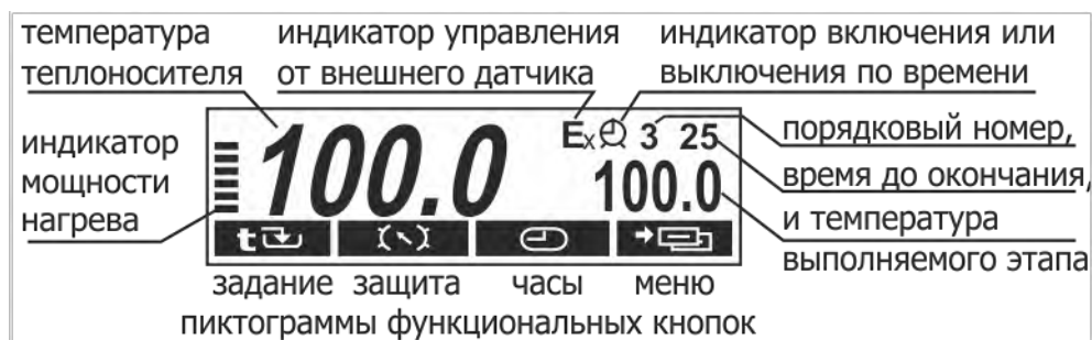
Рисунок 5 — Дисплей в режиме регулирования по программе
