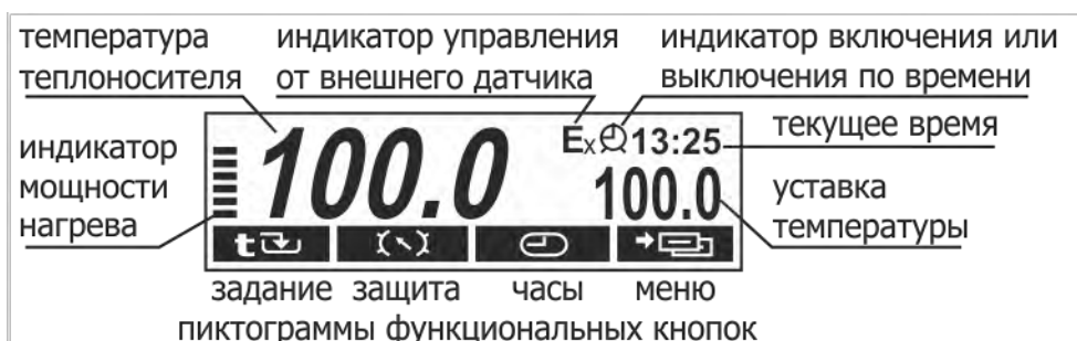
Рисунок 4 — Дисплей в режиме регулирования по уставке
